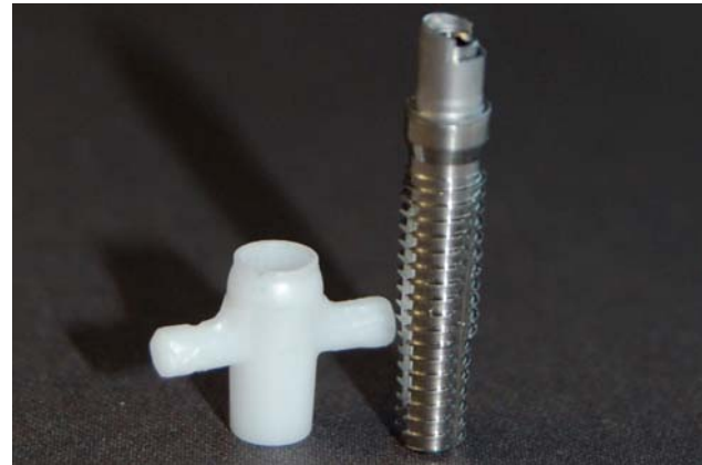
Abb. 2: Die Prüfkörper wurden aus ZrO_2 gefertigt.
